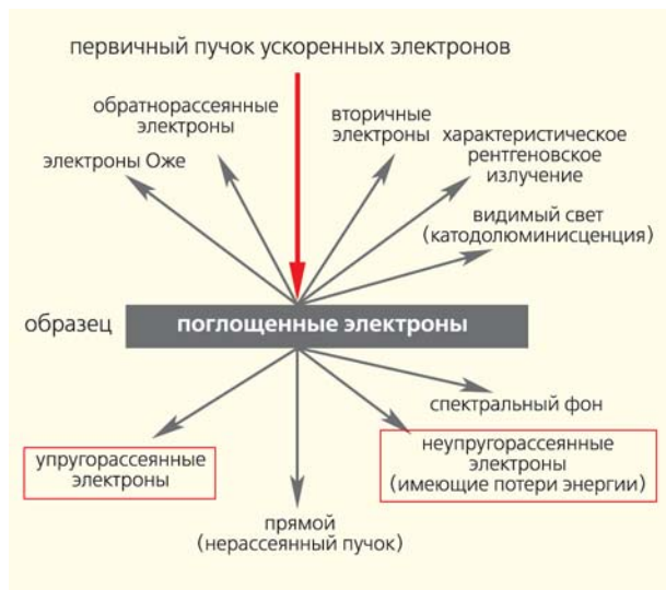
Рис.4. Распределение энергии пучка ускоренных электронов, прошедшего сквозь пленочный объект, и возникающие при этом вторичные излучения.
